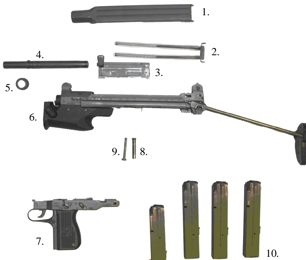
Fot. 5. Pistolet maszynowy PM-98, częściowo rozłożony: 1. pokrywa komory zamkowej, 2. zatrzask pokrywy ze sprężynami powrotnymi, 3. zespół zamka, 4. lufa, 5. nakrętka lufy, 6. zespół komory zamkowej, 7. zespół chwytu, 8. tulejka łącznika, 9. łącznik, 10. magazynki
