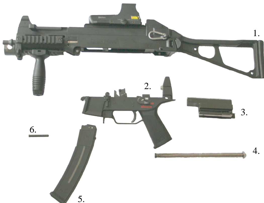
Fot. 13. Pistolet maszynowy UMP, częściowo rozłożony: 1. komora zamkowa z lufą, składaną kolbą i elementami, 2. komora spustowa z chwytem, mechani-
